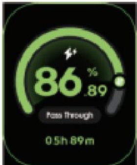
Entrada + saída (bypass ativado)
